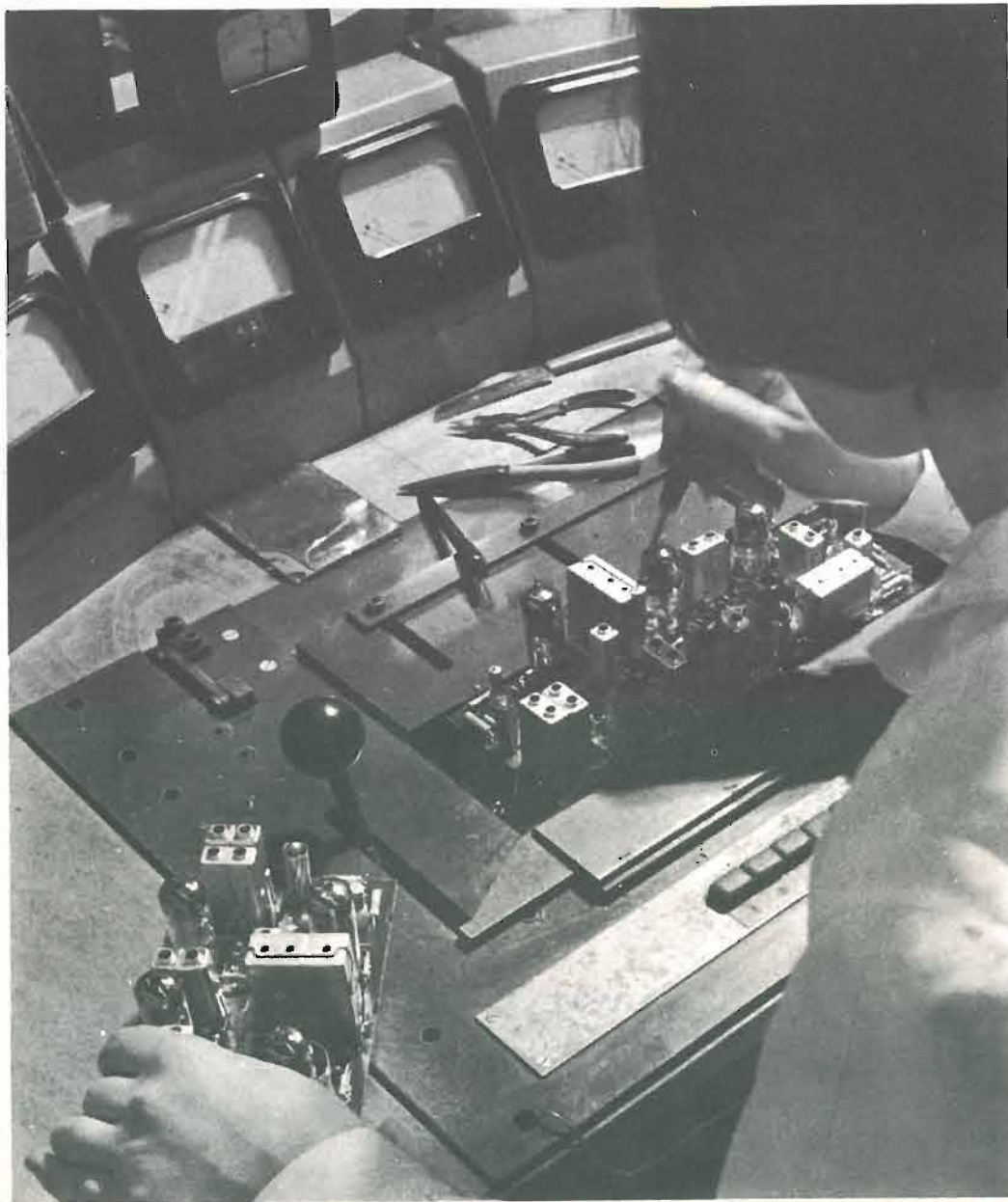
Banco di controllo per la taratura di un ricevitore AM/FM (fabbrica apparecchi Philips - Monza).
